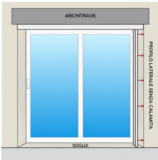
Posizionare il profilo laterale senza calamita della zanzariera a filo della guida superiore sul lato del piolo, inserendolo all'interno della guida superiore e assicurandosi che sia verticale (utilizzare una livella).
