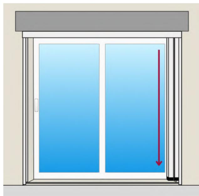
Mantenere la pressione verso l'alto portando la parte inferiore del cassonetto verso il profilo laterale.
