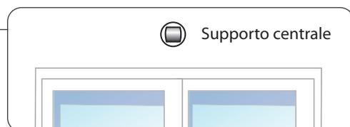
3 Infilare il bastone nel supporto centrale fino a posizionare la giunzione al centro del supporto.
